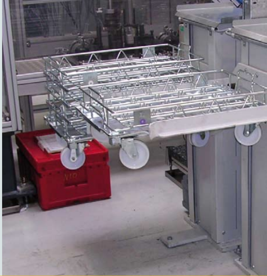
Kistenhubgeräte elektrisch / pneumatisch Boxlifter electrical / pneumatical
