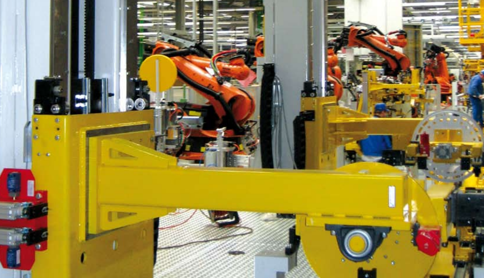
Hubgeräte Riemenantrieb Lift systems belt transmission
