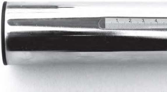
Version A) Nullpunkt gegenüber Handrad, von links nach rechts verlaufend; zero point opposite to hand wheel, from left to right
