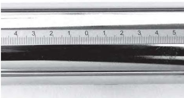
Version C) Nullpunkt aus der Mitte aufsteigend; zero point raising from the middle
