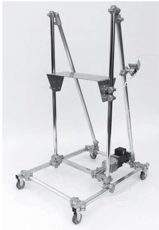
Fahrbares Hubgestell mit Motorantrieb aus Vierkant- und Rundrohren Ø 30 mm; Abkantblech als Sonderteil wird mittels Doppelschlitten vertikal positioniert.
