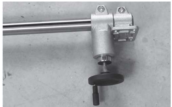
Winkelgetriebegehäuse in Klemmverbinderausführung mit Verstellereinheit Angle gear box in clamp design with linear unit
